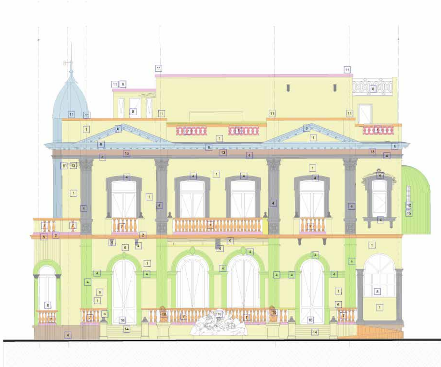
Marco de puertas, falta dirección, presencia de grietas, pintura en cantos, aplastados deteriorados.
